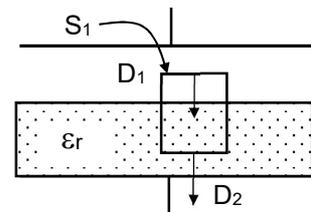
2) La d.d.p. attraverso tutto il condensatore è  $V(t) = V_{1,2} = \int_1^2 \vec{E} \cdot d\vec{l} = E_1 h_1 + E_2 h_2$
